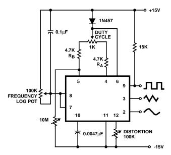
FIGURE 1. VARIABLE AUDIO OSCILLATOR, 20Hz TO 20kHz
