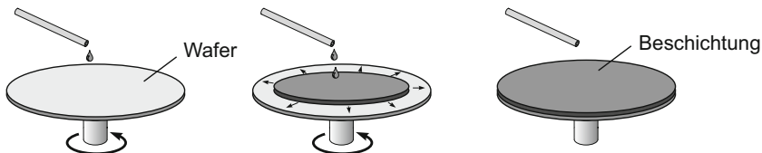
Abb. 12.11 Bei der Schleuderbeschichtung verteilt sich eine aufgebraute Flüssigkeit durch die Zentrifugalkraft gleichmäßig über den sich drehenden Wafer
