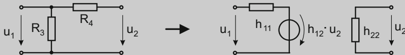
Abb. 10.16 Ursprüngliches Rückkopplungsnetzwerk und die entsprechende Schaltung in der Darstellung mit h -Parametern
