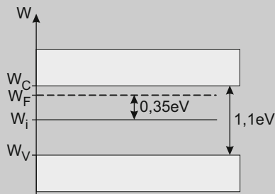
Abb. 1.24 Bei einem n-Typ Halbleiter liegt das Fermi-niveau in der Nähe der Leitungsbandkante
