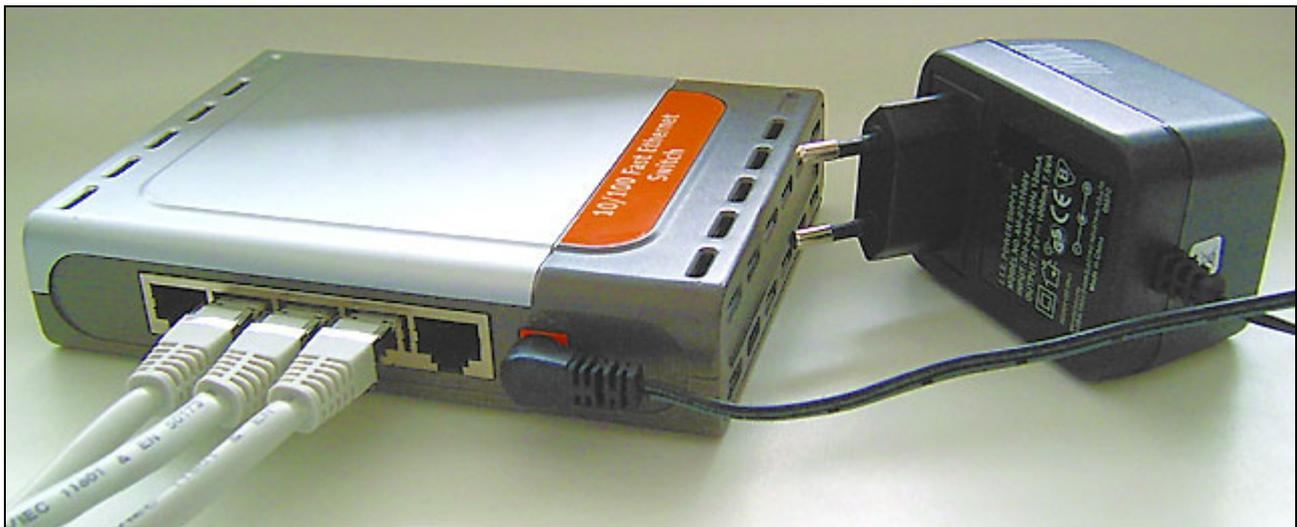
Abbildung 59: SWITCH-Rückansicht mit Patch-Kabeln für die drei Teilnehmer und Netzteil
