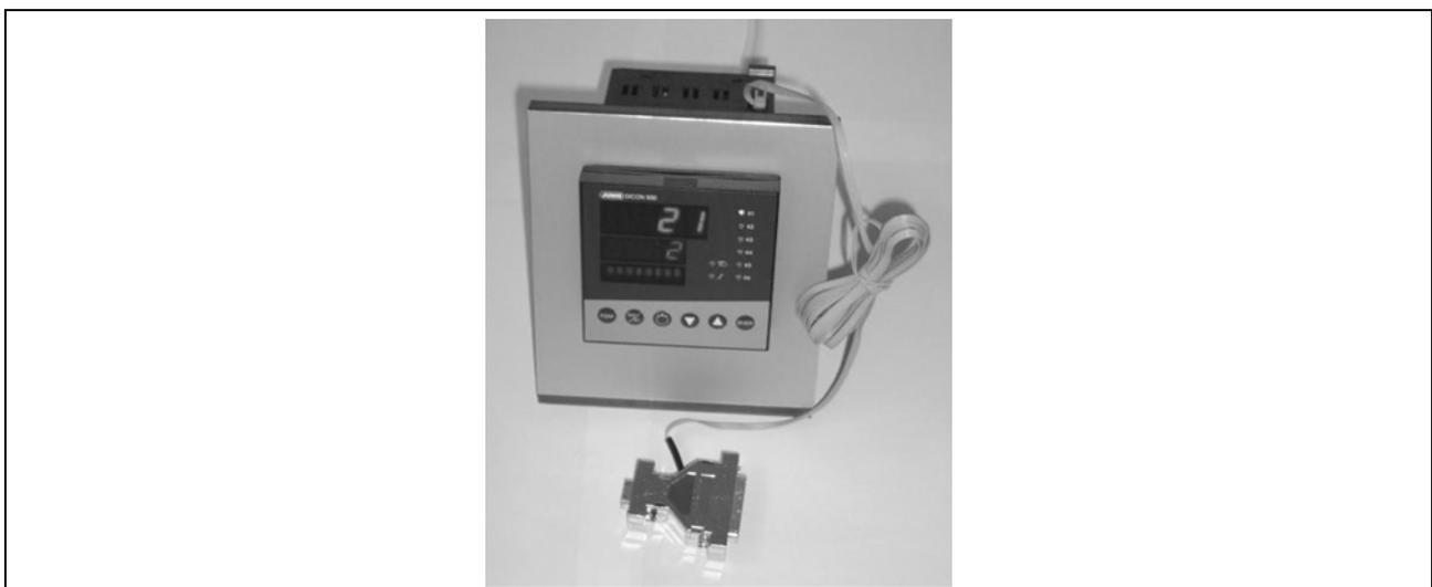
**Abbildung 16: Regler JUMO DICON 500 mit PC-Interface**
