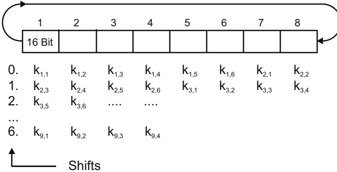
Abb. 2-9: Ableitung der 52 Teilschlüssel aus dem 128 Bit IDEA-Schlüssel.
