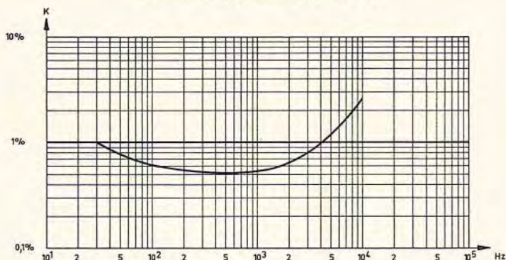
Klirrfaktor k in Abhängigkeit von der Frequenz bei 1/3 Aussteuerung (ca. 6W)
